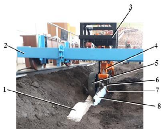
Рис. 1. Определение траектории движения сошника в лабораторных условиях
